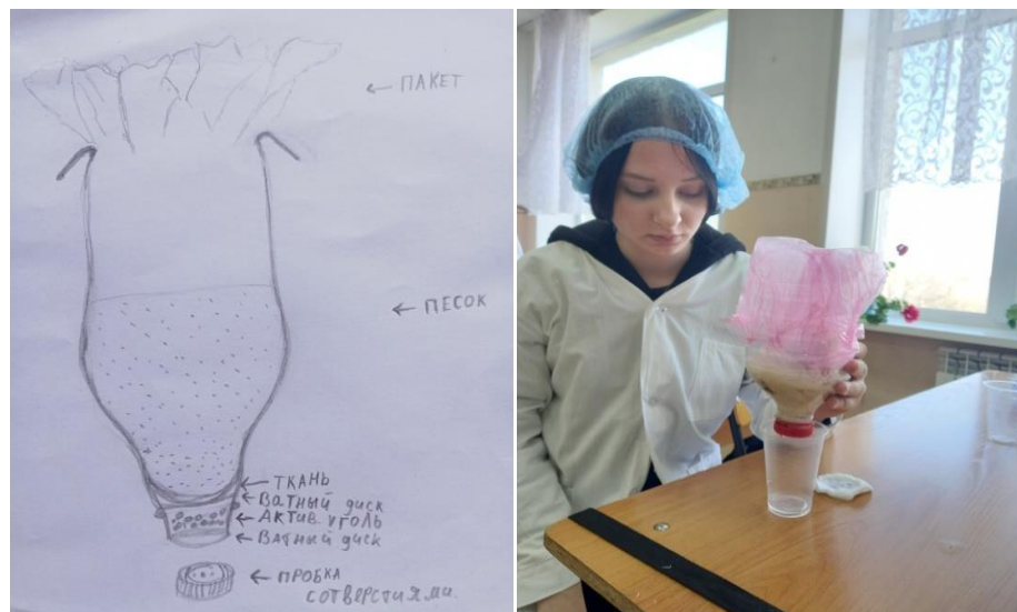
Рисунок 1 – Схема фильтра процесс фильтрации
